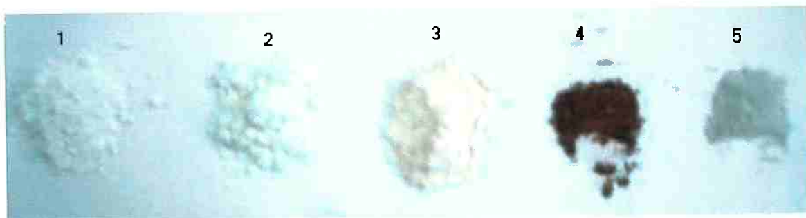
Figura 1: Foto das matérias-primas utilizadas para se fazer as amostras de porcelana de ossos. 1. Cinza de Osso; 2. Caulim; 3. Feldspato; 4. Óxido de Ferro ( \text{Fe}_2\text{O}_3 ); 5. Óxido de titânio ( \text{TiO}_2 ).
