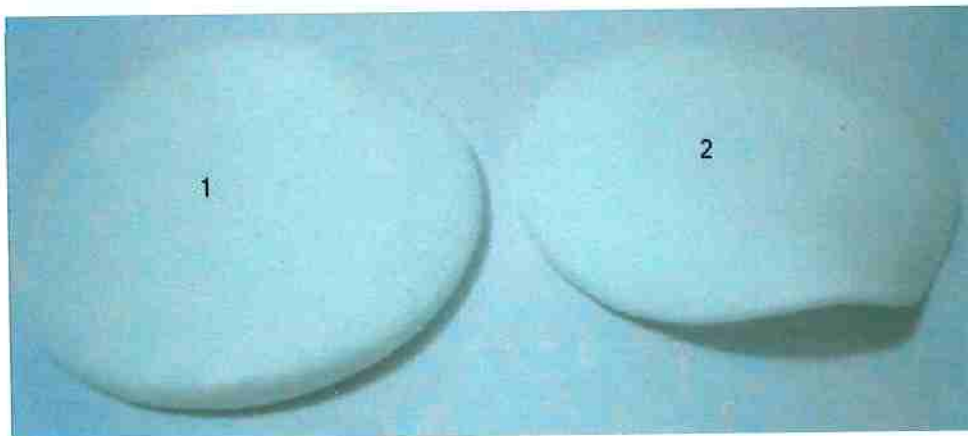
Figura 13: Foto das amostras empenadas com massa de porcelana de ossos básica (1) e com massa de porcelana de ossos com adição de 0,2% de \text{TiO}_2 .
