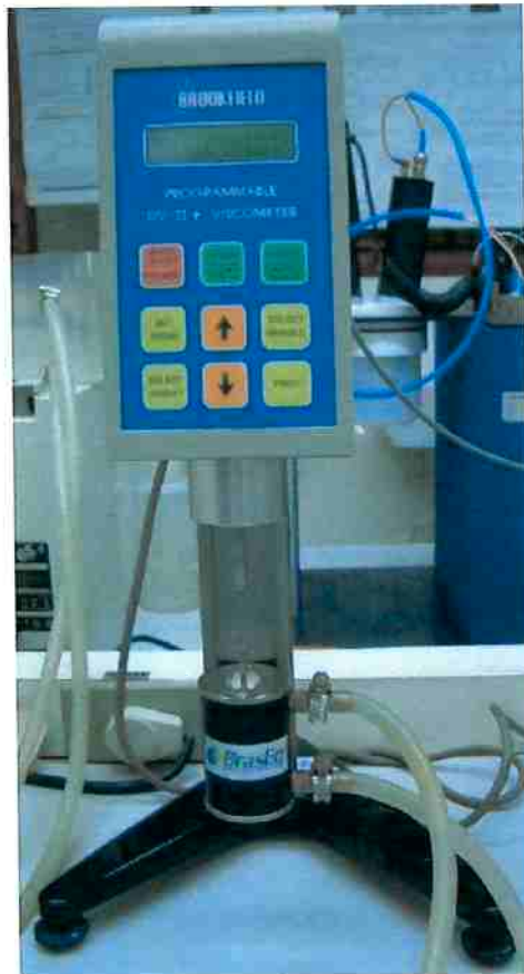
Figura 2: Foto do viscosímetro Brookfield modelo DVII+.
