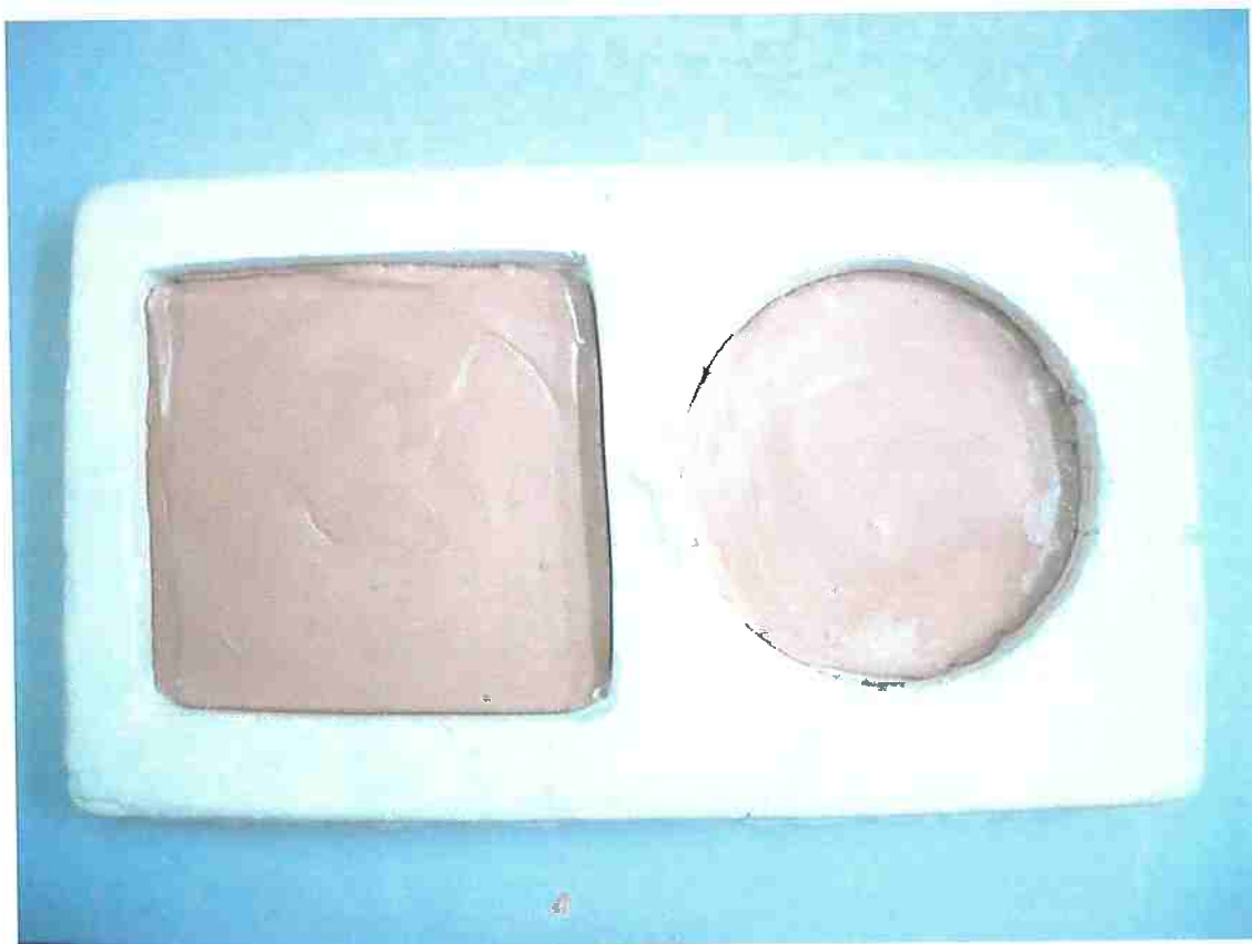
Figura 12: Foto do molde de gesso preenchido com a barbotina.
